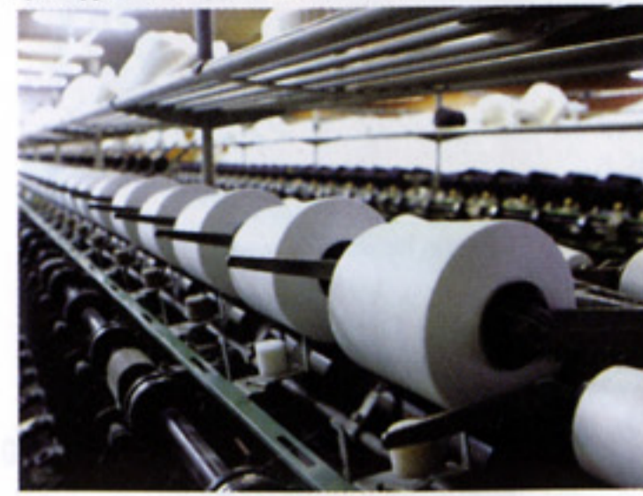
▲スピンドル(糸を巻いたポピンを回す棒状のもの)を回転させ、ねじり合わせながら上のロールに巻き取ります。紙糸の場合は乾燥しないよう、蓋で覆う形状にロール収納部を改良。
