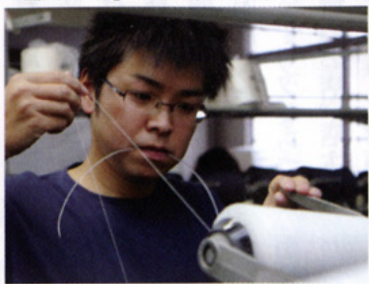
▲スピンドル(糸を巻いたポピンを回す棒状のもの)を回転させ、ねじり合わせながら上のロールに巻き取ります。紙糸の場合は乾燥しないよう、蓋で覆う形状にロール収納部を改良。
