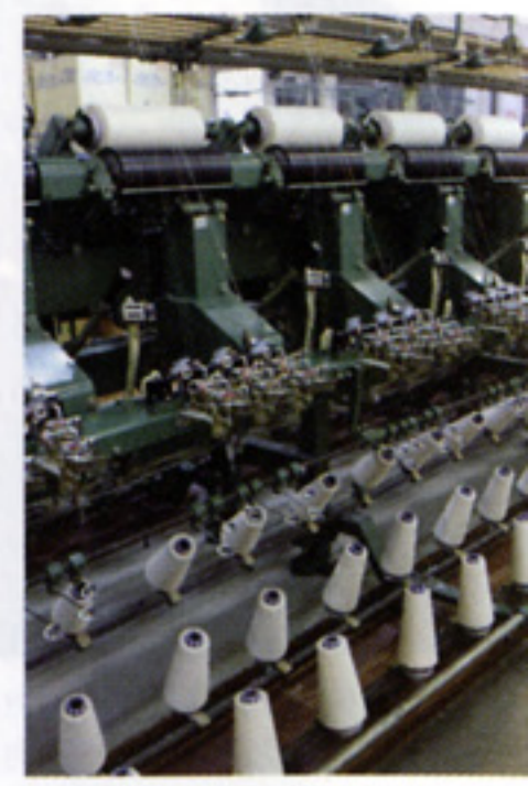
▲数本の糸を合わせて1本の束にしていく合糸工程。
