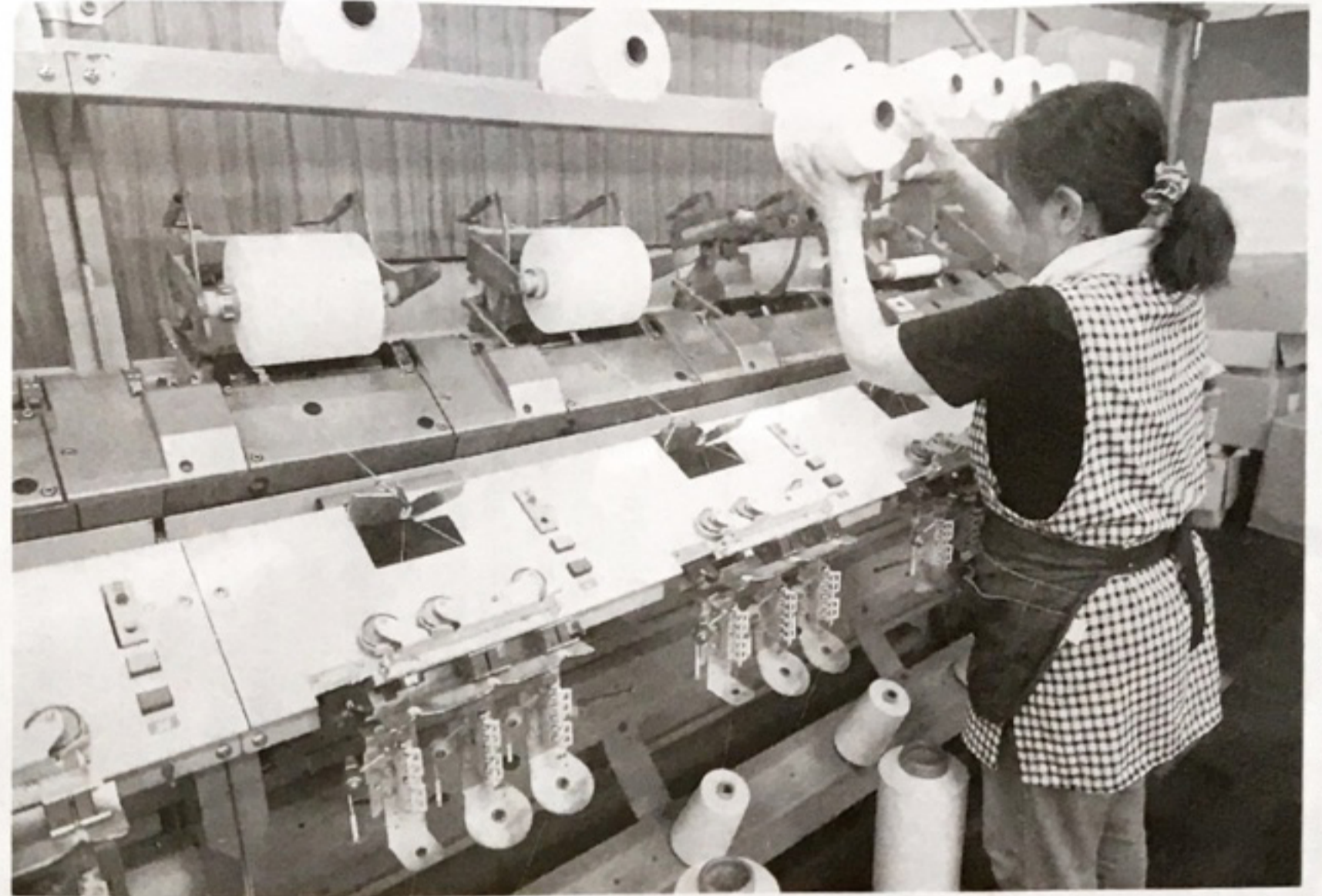
燃糸前に複数の糸を引き揃える合糸の工程は、「燃糸の命」と呼ばれるほど出来を左右する（上）、手前が和紙をスリットした原糸。その後合糸、燃糸の工程を経て和紙糸が完成する（下）
